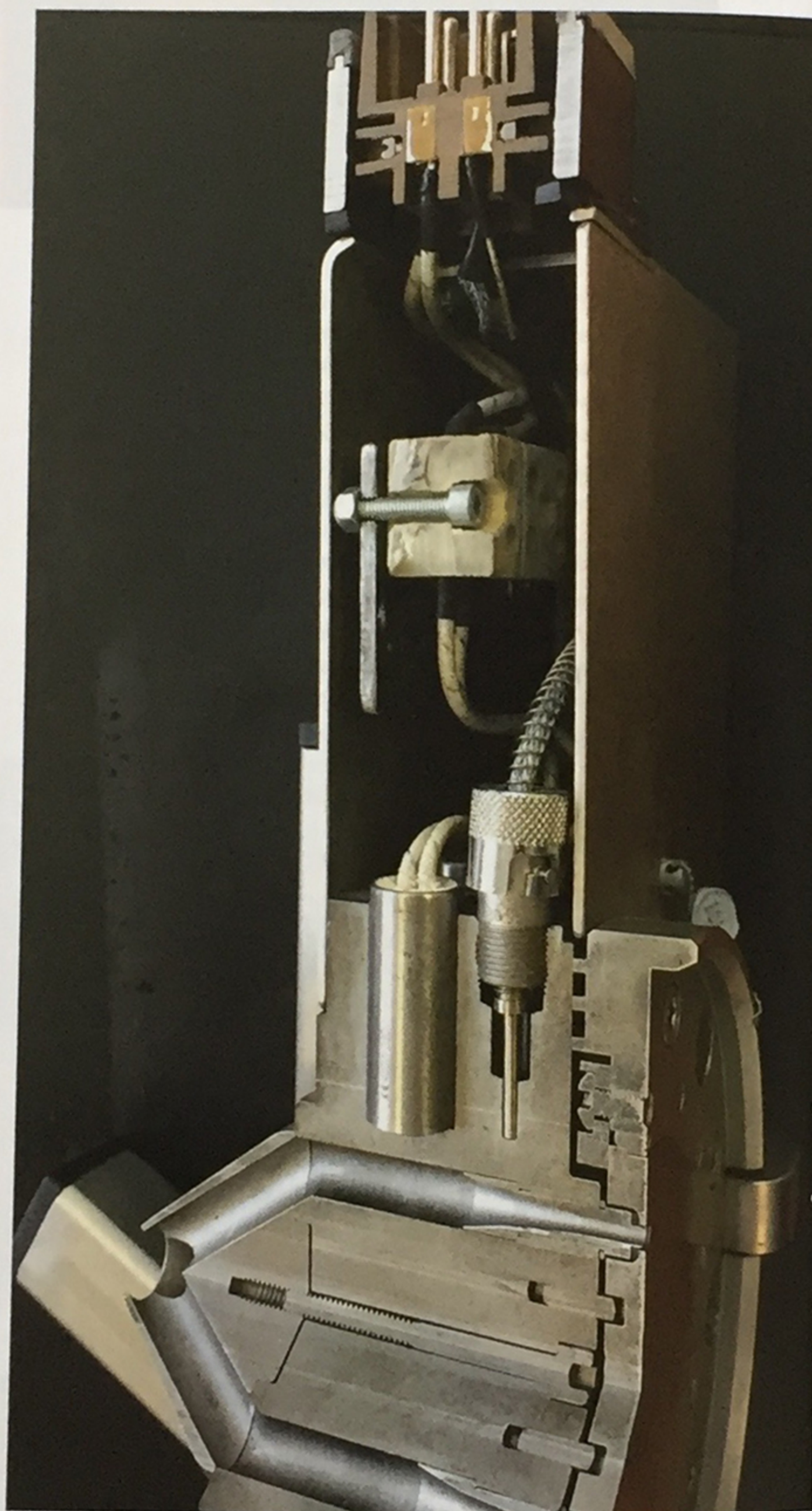
Een even simpele als briljante oplossing tegen warmteoverdracht: een laagje lucht tussen de extruder en de die-plate
