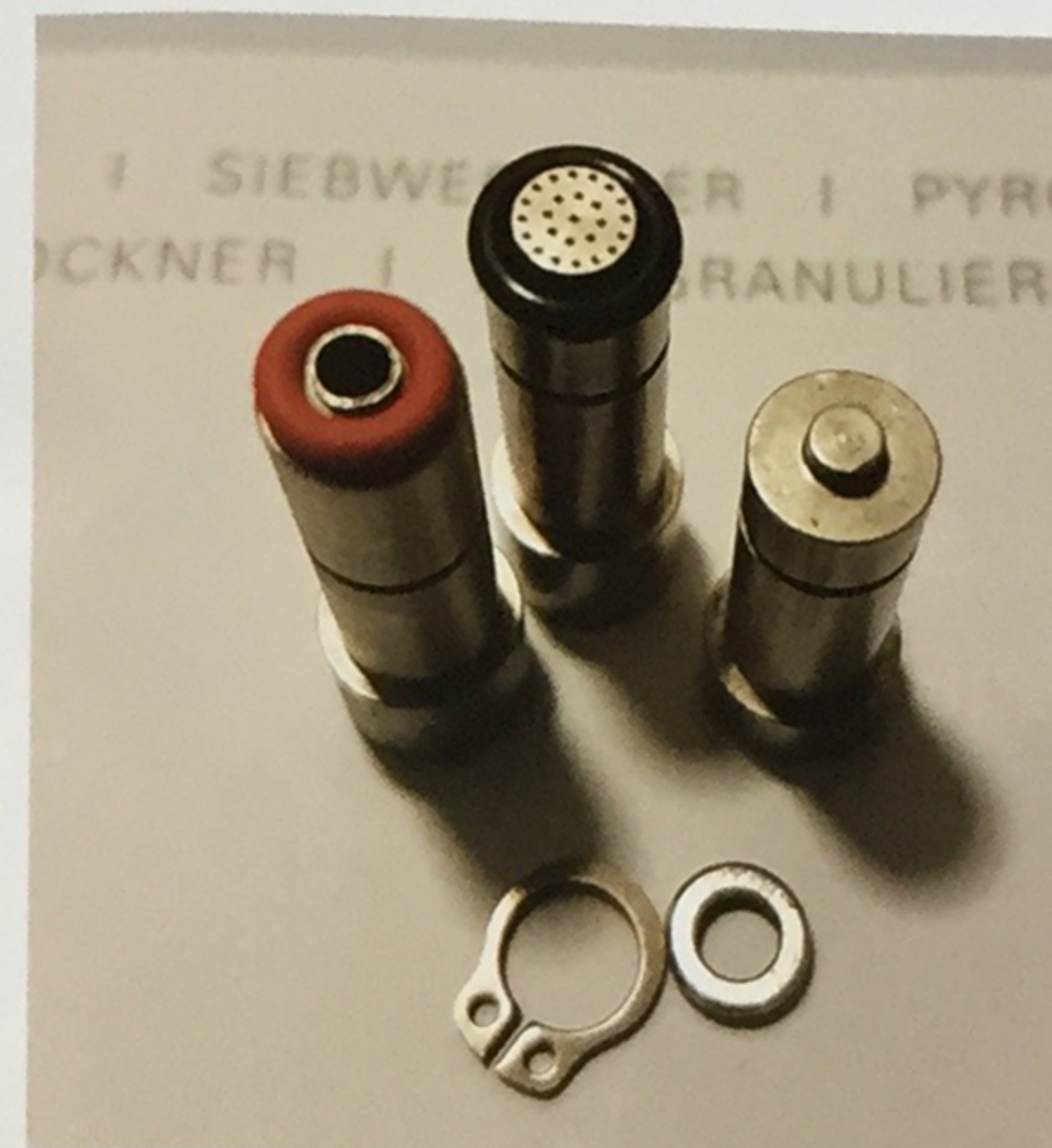
De rubber ringen rond de nozzles houden de die-plate 'op afstand' van de uitloop van de extruder
